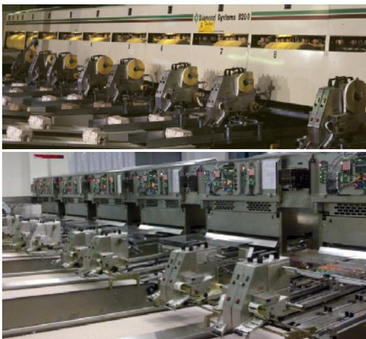
▪ OP60 Etikettiermaschinen in Aktion auf Packstationen. Diese Moba und Diamond Sortiermaschinen wurden mit OP60 ausgestattet.
